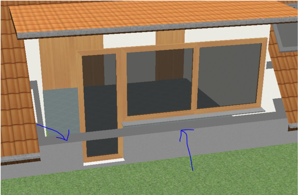
Damit sich die ursprüngliche Wand jetzt mit der Dachgaube verschneidet, zeichnen Sie im Konstruktionsmodus einfach an einem beliebigen Punkt eine Wand in Ihr Projekt (diese können Sie anschließend wieder löschen), nun berechnet das Programm die Verschneidung der Wand und des Daches neu:
